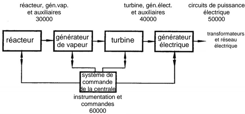
**Figure 26.5 Divisions de la numérotation des appareils**
